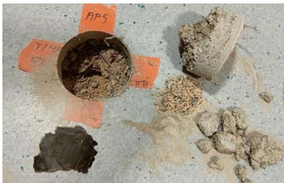
Kuva 13 Alapohjan eristeenä on toja.
