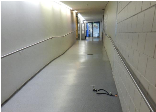
Kuva 177. Viiltomittaus käytävällä 1040, V3: 83,7 %RH.
